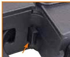
1. El Hop-Up se encuentra en la ventanilla inferior para la salida del cartucho. Tire de la palanca tensora hacia atrás para acceder a la ruedecilla de ajuste del Hop-Up.
