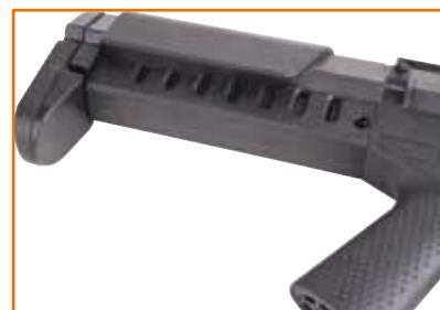
**1.** Le dispositif de blocage de la crosse se trouve en avant de la plaque de couche. Il doit être comprimé des deux côtés pour régler la crosse à la longueur souhaitée.
