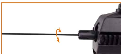
**4.** Führen Sie das Ende mit dem Stoffstreifen mit einer Rotationsbewegung von vorne in den Lauf ein.
