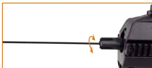
4. Introduzca con un movimiento de rotación el extremo envuelto en algodón en el cañón por la parte delantera. Para ello, retire primero la tapa de la boca del cañón y desactive el Hop-Up.
